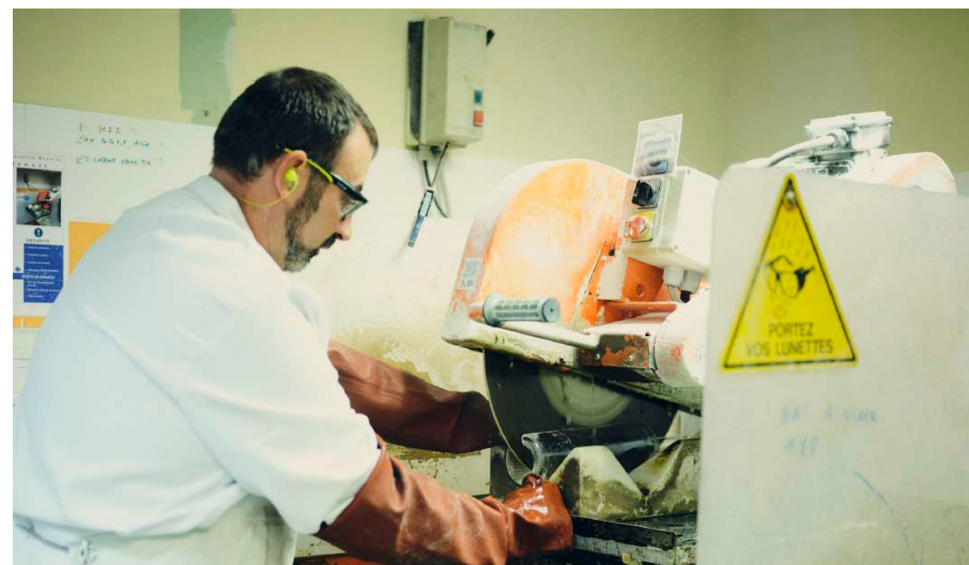
↑ Découpe d'une bouteille pour vérifier la qualité de répartition du verre
